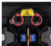
②松开固定在电极盖的螺丝,取出电极盖。
