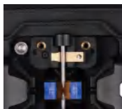
③取下旧的电极棒,装上新的电极棒,再将电极盖装回复原。同理更换另一电极即可。
