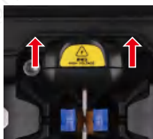
①关机后打开防风盖,推开电极盖上的螺丝盖。
